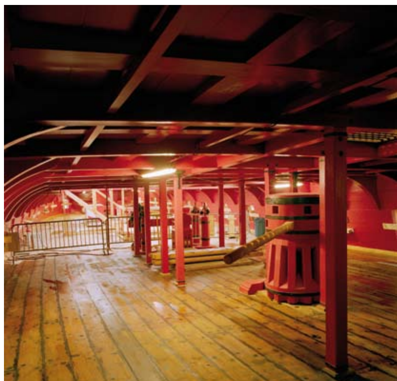
Le pont de batterie. À droite, le grand cabestan.
