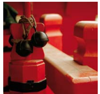
Contrepoids sur le piston d'une pompe de cale.
