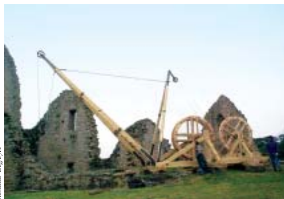
Grue de levage à roues (XIV e -XVI e ), conservatoire des machines de guerre médiévales, château de Tiffauges.
